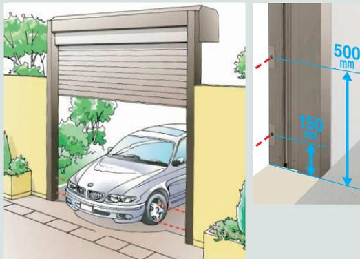
2ヶ所の光電センサーで障害物を感知。シャッターが動作中にセンサーが障害物を感知すると、動作を停止。寒冷地でも安心して使えます。
