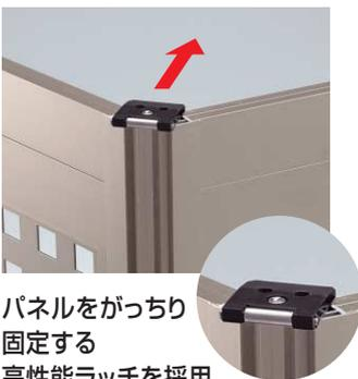
パネルをがっちり固定する高性能ラッチを採用。パネル本体を上レールにしっかりと固定。クローズ時の本体のたわみやバタツキを抑制しました。
